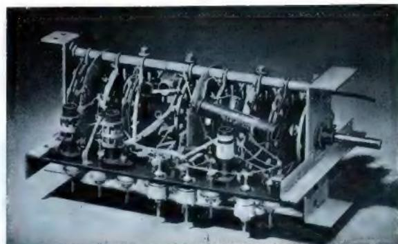
Zusätzlich zu Mittel- und Langwellenbereich und dem durchgehenden Kurzwellenbereich (13... 51 m) sind drei Wellenschalterstellungen vorhanden, bei denen entsprechende Kondensatorkombinationen in Serie bzw. parallel zu den Abstimmkondensatoren des Oszillatorkreises und der Vorkreise gehalten werden, um das 19-, 25- und 31-m-Band auf die ganze Skalenlänge auseinanderzuziehen, so daß auf diesen drei wichtigen Bändern die Abstimbarkeit und das Wiederfinden von Sendern erheblich verbessert werden.
